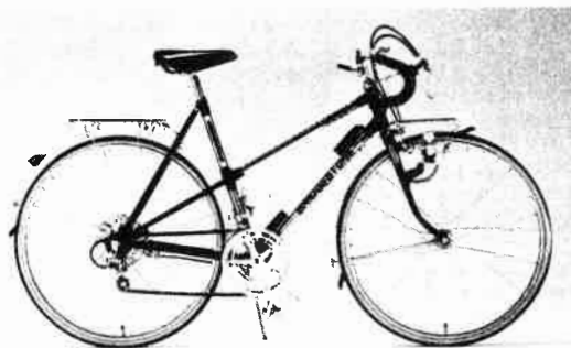
Die Damenversion mit Rennlenker und Sicherheitsbremshebeln
