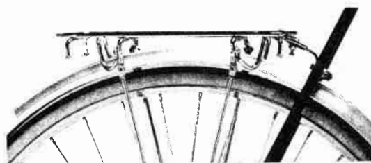
Der pfiffige, ausklappbare Gepäckträger mit zahlreichen Befestigungsösen für Spanngurte
