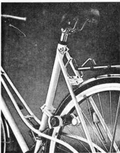
HP TURBO Vario: Bremsenträger zum Anschrauben am Sitzrohr.
