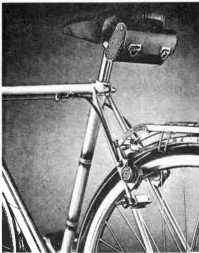
HP TURBO Standard: Bremsenträger zum Anschrauben an der Pletscher-ESGE-Platte
