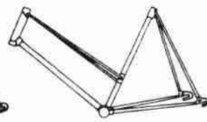
"Jumelle"-Rahmen (mit zwei zum Sitzrohr laufenden Oberrohren)
