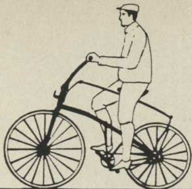
André Guilmet zeigt auf der Pariser Fahrradausstellung das erste Niederfahrrad mit Kettenantrieb (1869)
