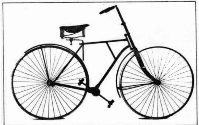
Die F. N., in Belgien baute 1889 erstmals ein Parallelogrammrahmen-Safety mit Kardanantrieb.
