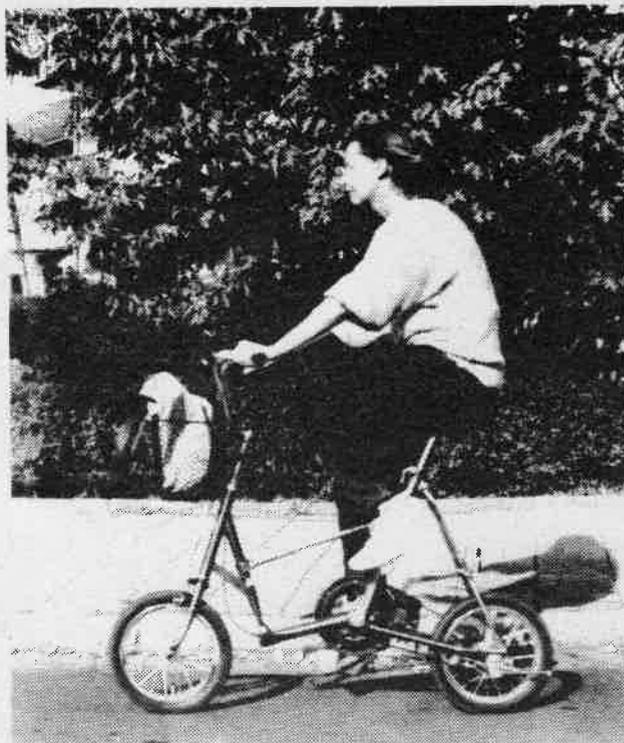
Bei schnellerer Bergabfahrt müssen die Hände am Lenker Ruhe bewahren: Das "Picnica" antwortet sehr direkt auf Lenkbewegungen. Neben der modernen Kraftübertragung wirken die beiden Bremsen, hinten die in Japan übliche Bandzugbremse, vorn eine Seitenzug-Felgenbremse, recht einfach. Aber zum größten Erstaunen aller Benutzer war die Verzögerung vorzüglich, mit den üblichen Abstrichen bei Nässe. Die Felgenbremse be-
