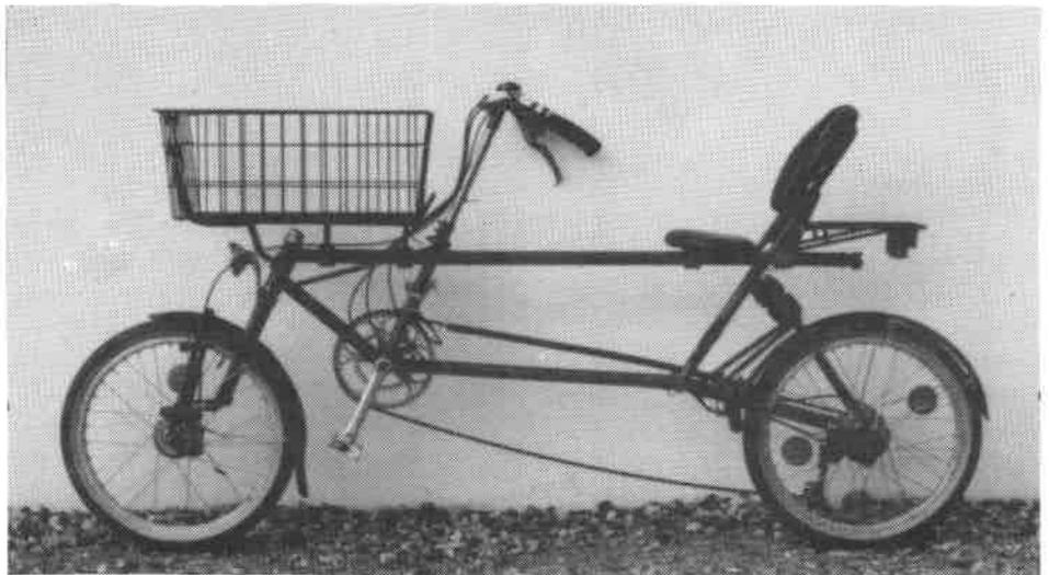
ten kann der Sitz bis über das angetriebene Rad rutschen. Bei einer Gesamtlänge von 1.920 mm ist das Rad nicht länger als ein herkömmliches Tourenrad.
