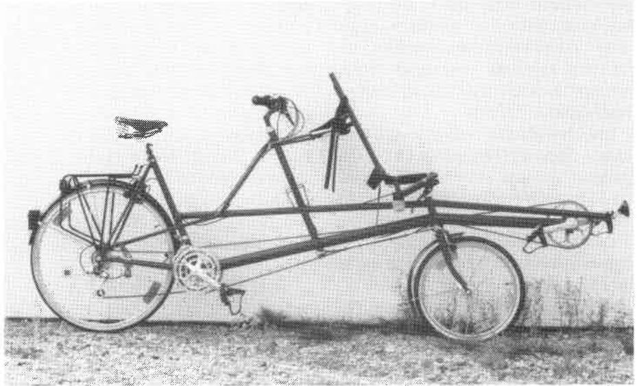
Stoker sitzt genau über dem Vorderrad. Denkbar wäre, daß dieser Schiebefeffer durch die Verwendung einer anderen Vorderradbereifung (Radius verwendet eine BMX-Bereifung) entschärft werden könnte. Andererseits trägt diese voluminöse Bereifung zum Fahrkomfort des Stokers bei, denn der sitzt genau über dem kleinen Vorderrad, das die Unebenheiten der Fahrbahn besonders stark auffangen muß. Allerdings schützt die Sitzfederung des Liegeradsitzes den Vordermann vor den heftigsten Stößen.
