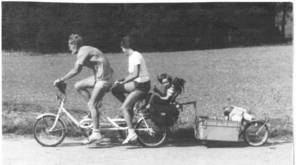
Gespann mit WIPO Fahrradanhänger "Radelboy". Die umgebaute Deichsel nebst Kupplung ermöglicht es, den Gepäckträger des Zugfahrzeugs voll zu nutzen, hier sogar mit einem Kindersitz.
