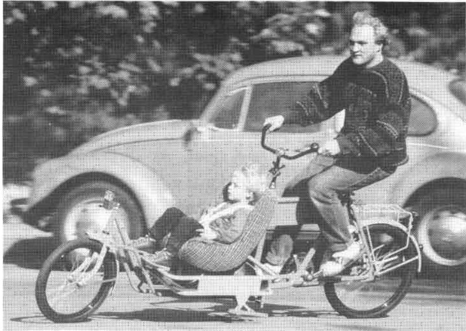
erst kurz vor dem Vorderrad steil nach oben zum Steuerkopf ab. Die Führung des Vorderrades übernimmt eine Gabel, wie sie vom Klapprad her bekannt ist, allerdings stabiler.
