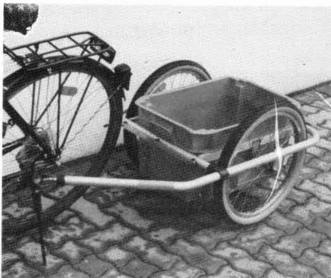
Prinzip der raschen Demontierbarkeit untergeordnet wurde (fehlende Schutzbleche). Die schmale Spurbreite führt dazu, daß das rechte Rad fast auf der Spur des Zugfahrzeuges rollt (siehe Abb.) mit dem Ergebnis, daß bei schlechtem Wetter der Straßendreck in den Rücken des Radlers geschleudert wird.
