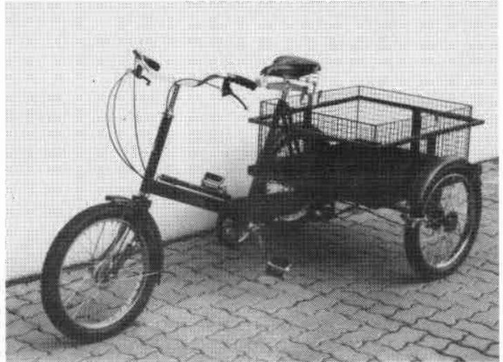
Auf der Ebene bei mäßigen Geschwindigkeiten bringt die Bremsanlage (vorne SA Trommelbremse 80 mm Durchmesser, hinten 2 Seitenzugfelgenbremsen auf Stahlfelgen, von einem Bremshebel mit Doppelbremszug bedienbar) das Fahrzeug zum Stehen, bei extremeren Situationen (Nässe, Gefälle) dürfte es Schwierigkeiten geben. Besonders die hinteren Felgen sind dann kaum wirkungsvoll. Eine Lichtenanlage - typisch britisch - fehlt. Das "Middleweight" ist in der Dreigangausführung für 2.345,- DM zu haben.
