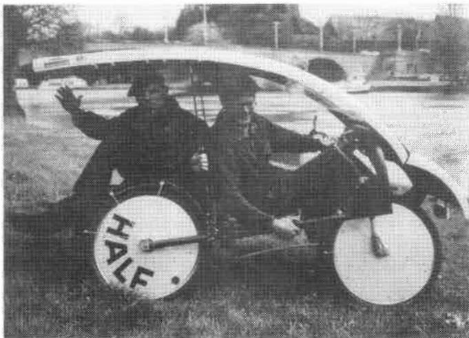
Bild 2. HALF 2 als Rallyefahrzeug im April 1995 vorgestellt mit 1,5 qm Photovoltaischen Modulen, L = 2,25m B = 0,94m H = 1,35m, 2 Sitze bzw. Fahrersitz + zusätzliche Batterielast, Auslegungsgeschwindigkeit 25 km/h
