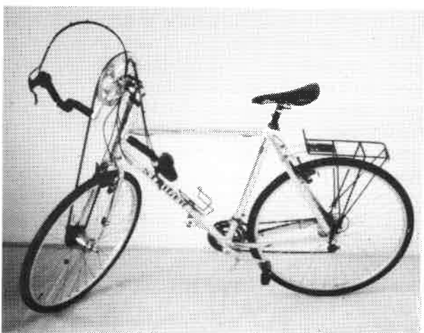
"Bi-Bike" mit Doppelantrieb: Neben dem herkömmlichen Tretantrieb kann das Vorderrad über den als Kurbel ausgebildeten Lenker angetrieben werden.
