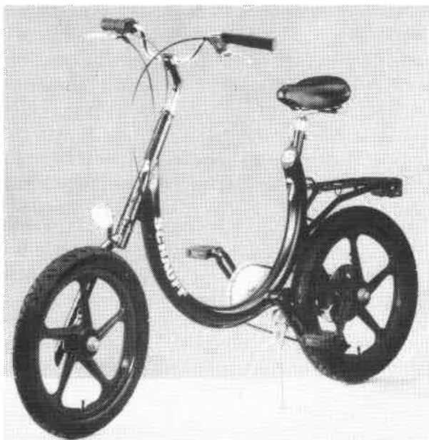
"La Luna" von Schauff. Hier noch mit einseitiger Rad-aufhängung. Aus Sicherheitsgründen wird das Serienmodell zweiseitig aufgehängt sein.
