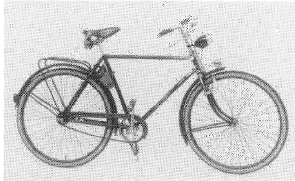
Miele-Tourenrad von 1950. Typisch für diesen Fahrzeugtyp der lange Radstand, der "NSU-Lenker" mit Gestänge-Vorderradbremse, stabilem Gepäckträger aus gebogenem Stahlrohr, Ledersattel mit Doppelspiralfeder, Werkzeugtasche und Firmenemblem auf dem vorderen Schutzblech. Foto aus: J. Franke, Illustrierte Fahrrad-Geschichte , Berlin 1987, S. 135
