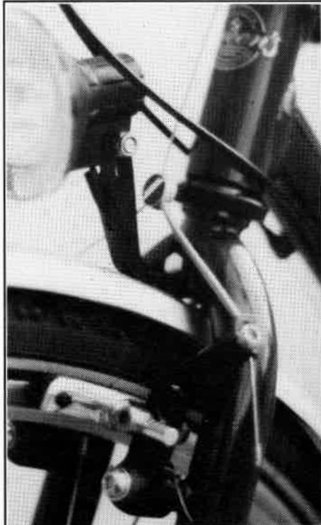
Moderne Bremszugverlegung. Zu sehen ist die Bowdenzugklemmung (Inbus) am Ende des Cantilverarms.
