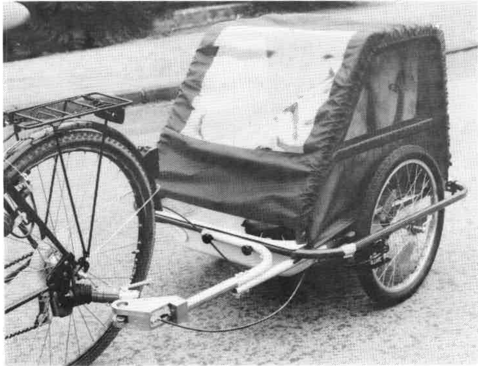
Fahrradgespann mit Auflaufbremse. Das Bild zeigt das MAGURA-Hydrauliksystem.
