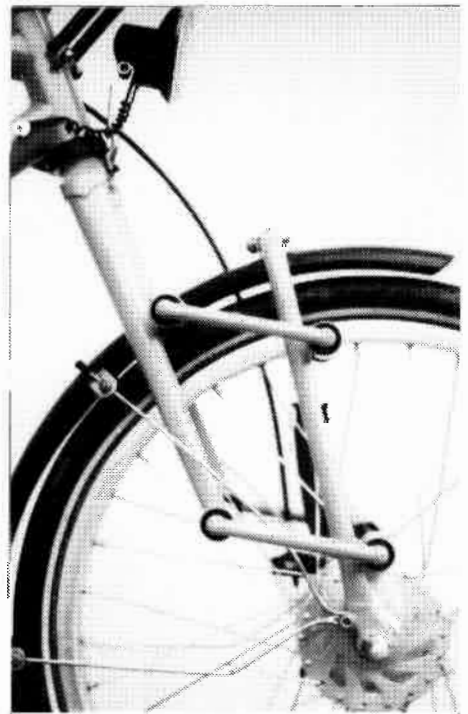
Aufwendige Vorderradfederung. Ferner sind am Steuerkopfrohr die Anlöten für die Gepäckträgerbefestigung und die Lichtkabelverschraubung als Detaillösungen zu sehen.
