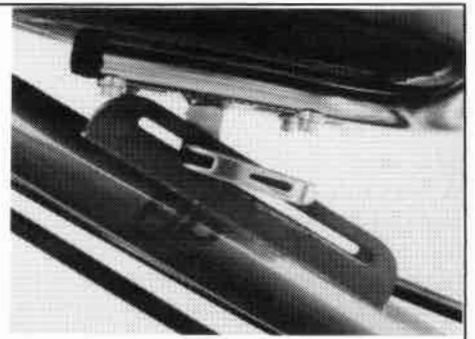
Sitz und Sitzverstellung beim Wavey. Links der geteilte Sitz mit der geschwungenen Rückenlehne und der gebogenen Neigungsverstellung. Oben die angeschweißte Führungsschiene mit Langloch und Schnellspannern für die Längenverstellung.
