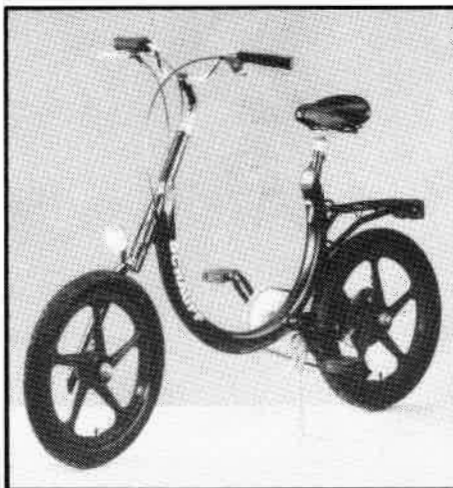
„La Luna“ Prototyp: Einseitige Radaufhängung, Scheibenbremse hinten, Trommelbremse vorne, Zweibeinständer.
