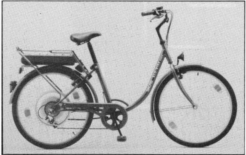
Das Elo-Bike Modell „Classic“ (im Text wird der „Tramper“ beschrieben). „Classic“ hat einen Einrohrrahmen und ist mit einer 7-Gang-Kettenschaltung ausgerüstet, „Tramper“ hat den klassischen Diamantrahmen und 21 Gänge. Das Antriebskonzept ist bei beiden Varianten gleich: 24-V-Gleichstrommotor in der Hinterradnabe, Akku-Paket im Gepäckträger integriert. Preise: Beide Modelle ca. 2.600,- DM
