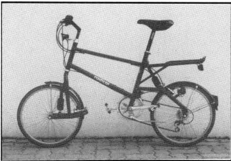
Das Stadtrad RADICAL (siehe Pro Velo 43): Gesamtlänge 153 cm, 20“ Laufräder, Federung vorne / hinten, Kettenschaltung, Gewicht ca. 15 kg
