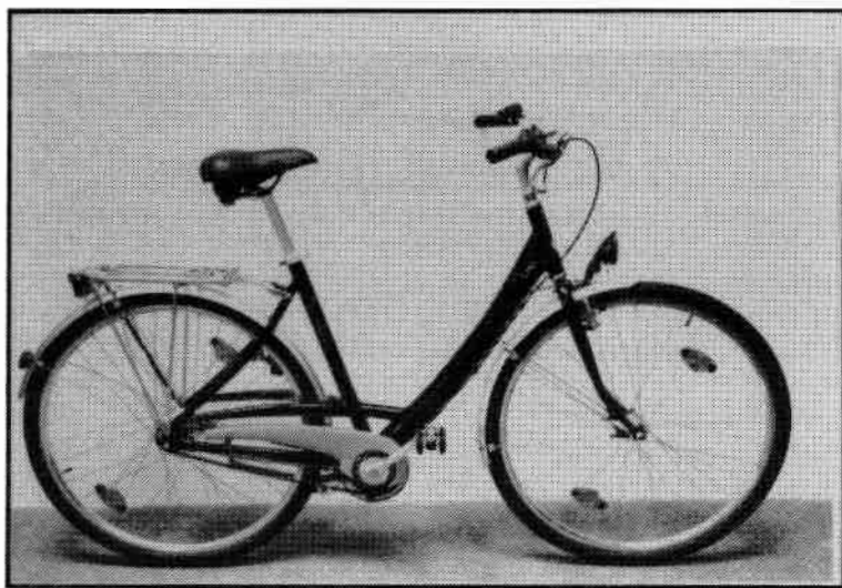
Das Stadtrad S 140 der Fahrradmanufaktur: 28“-Laufäder, Einrohr- rahmen mit Tragegriff (garantiert tiefen Durchstieg und Flexibilität), 7-Gang-Nabenschaltung mit Rücktrittbremse
