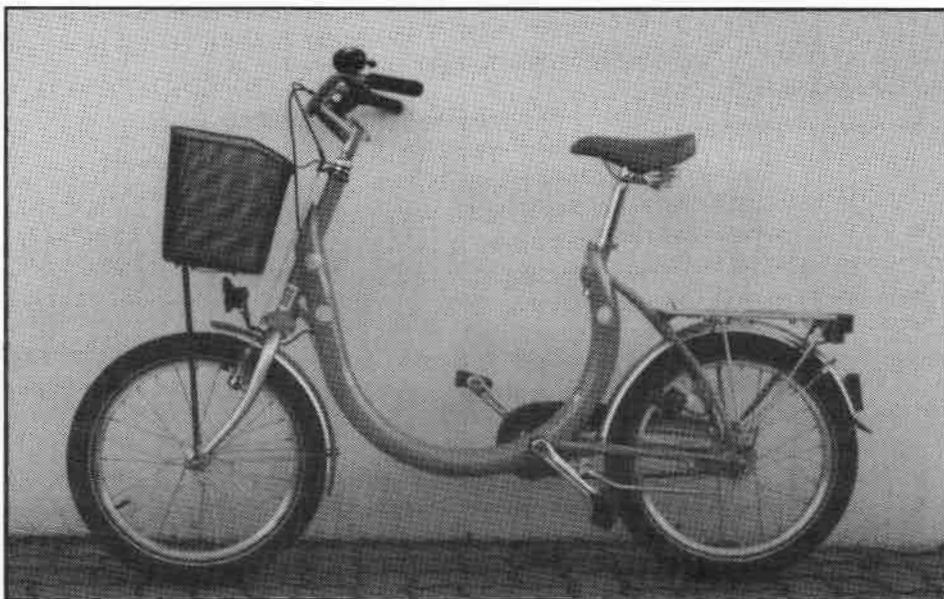
„La Luna“ in der Serienausführung mit 4-Gang-Rücktrittnabe, Cantilverbremse vorne, zweiseitige Radaufhängungen, Seitenständer.
