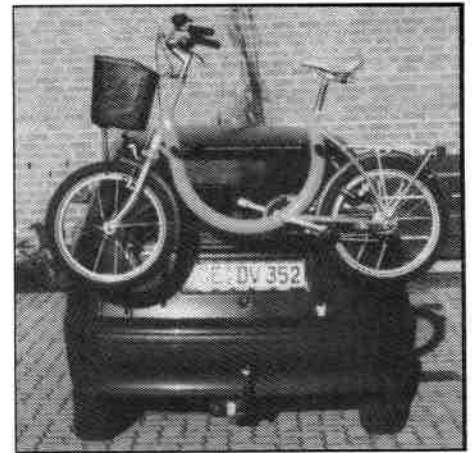
La Lunas Transport auf dem Heckträger. Damit das Kennzeichen frei bleibt, ist der Träger sehr hoch montiert. Dadurch gelingt keine stabile Befestigung am Fahrzeug.
