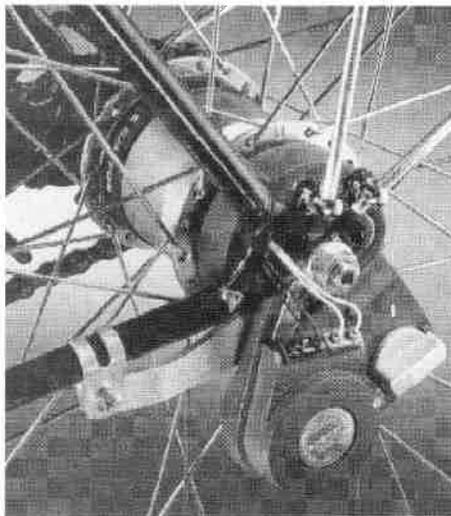
Der Dynamo „Spectro -V6“ von SRAM wird an die Hinterradnabe montiert. Mit Hilfe unterschiedlicher Adapter (siehe Bild unten) ist dieser Dynamo sowohl für Ketten- als auch Nabenschaltungen geeignet. Das Funktionsprinzip ähnelt dem des FER 2000, der Antrieb erfolgt hier nur nicht durch einen Zahnriemen, sondern durch mehrere Nylonzahnräder (mehrstufiges Getriebe).
