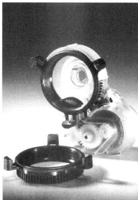
dem Rahmen nehmen, Dynamo aufstecken und das Rad wieder einbauen. Über Doppelstecker wird die Verbindung zu den Leuchten hergestellt. Der Dynamo von SRAM hat ein drehzahlerhöhendes Getriebe, das über einen Schalter am Generatorgehäuse an- und abgekoppelt wird. Abgeschaltet läuft er im Gegensatz zu getriebelosen Nabendynamos nicht mit. Der „Spectrolux V6“ („V6“ steht für sechs Volt Spannung) soll in diesen Tagen in den Fachhandel gelangen und dort unter 90 Mark kosten.
