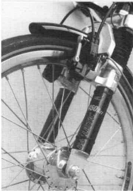
Federgabel vorne mit MAGURA-Hydraulikbremsen und Nabendynamo SON
