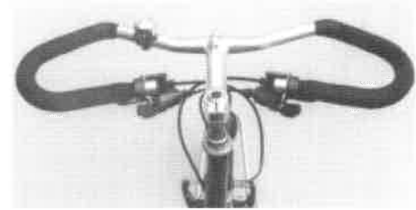
oben: Mehrfunktionslenker; dadurch sind verschiedene Griffmöglichkeiten gegeben, die Druckstellen und Kribbeln an den Händen verhindern helfen; Bedienung der Schalt- / Bremshebelkombination erfolgt aus einer mittleren Griffposition heraus.
