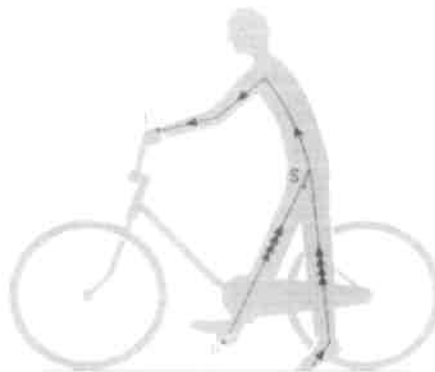
Abb. 7: Wachstum und Stellgrößen Die Regel „Standssicherheit“ setzt am Berührungspunkt zum Boden an. Indirekt gilt ähnliches auch für die Regel „Ergonomischer Tritt“: Der dynamische Berührungspunkt der Pedale bestimmt die Pedalhöhe. Beide Regeln führen folgerichtig zu wachstumsorientierten Stellgrößen von unten nach oben bzw. nach vorne. Das Wachstum des Oberkörpers muß nach vorne ausgeglichen werden, wenn die Sattelposition nicht an Funktionen überfordert werden soll.
