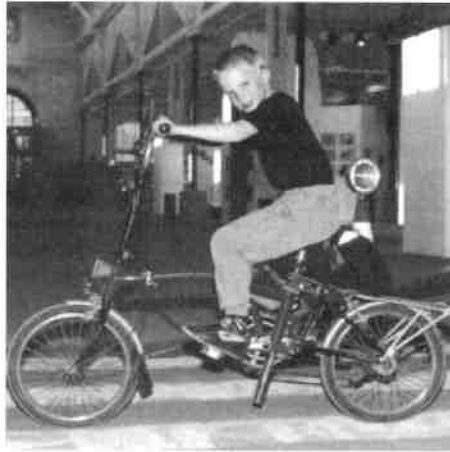
Abb. 6 (links): Asynchrone Verstellung am Beispiel Faltrad. Das Brompton paßt erfahrungsgemäß am besten für kleinere Erwachsene. Die beiden Fotos zeigen exemplarisch, daß die Sitzlänge sich allein durch die Sattelstütze anpassen läßt. Erstaunlicherweise wird hier nicht mal die Möglichkeit des hochgestellten Lenkers genutzt, die Ausladung zu ändern. Dennoch: Die Sitzposition des Jungen ist ungeeignet und verkrampft. Die Anpassung der Sitzlänge geht auf Kosten der Winkellage der Arme. Die langen Kurbelarme schieben die Beine hoch, und der Radstand eignet sich eher für Geradeausfahrten.
