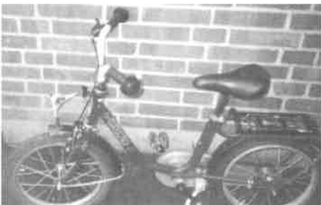
Abb. 8: „Standsicherheit“ und „ergonomischer Tritt“. Die beiden Anforderungen sind bei diesem älteren Modell „Maus“ / Fa. Enik dank niedrigerem und steigendem Sitzwinkel erfüllt. \alpha = 73^\circ , \beta R = 70^\circ , \beta V = 64^\circ für niedrigste Sattelstellung, schwach ansteigen.
