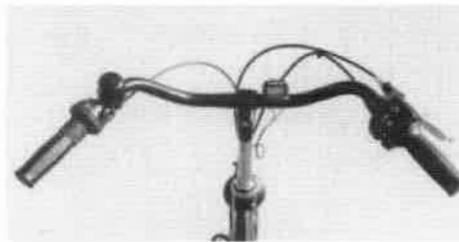
Lenker mit Bedienelementen aus Fahrersicht Rechts Bremsgriff mit Drehschalter für den Antrieb. Links Drehgriff für die Schaltung, Ziffern stehen auf dem Kopf, da der Griff für die Montage rechts ausgelegt ist.
