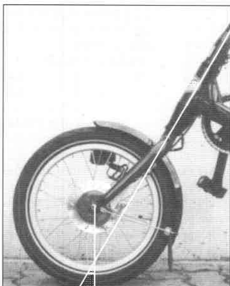
Nachlauf „N“ hängt von der Gabelkrümmung ab. Wäre die Gabelkrümmung geringer, würde die Laufradmitte weiter nach rechts wandern und damit „N“ vergrößern.
