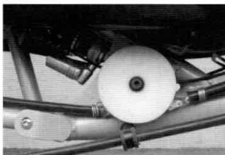
Große Umlenkrolle, Kettenlinie knapp über Drehpunkt
