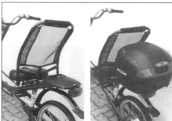
Gepäckbox Topcase SH 25 mit 25 Litern Fassungsvermögen. Links der Gepäckträger, mit dem die Box fest verriegelt und verschlossen werden kann.
