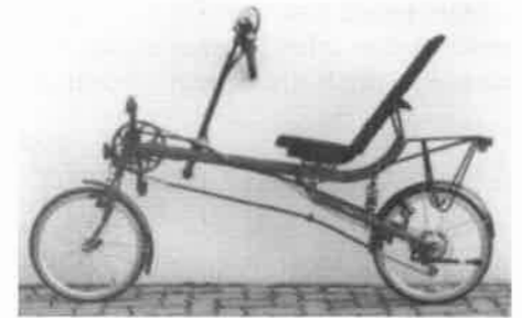
Bild 7: Kompaktlieger „Red Pepper“ mit indirekter Lenkung oben
