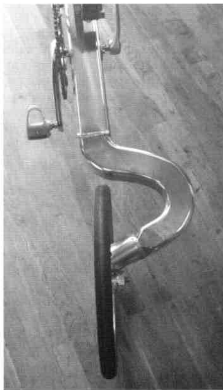
Liegerad DIMA aus Alu-Blech geformte Profil-Bauweise mit Achsschenkelenkung vorne (siehe zu diesem Fahrzeug ausführliches Typenblatt in PRO VELO 26, S. 40)
