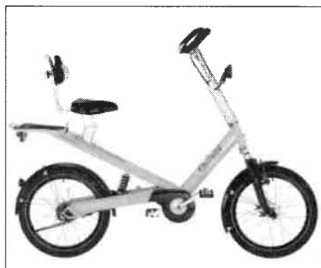
Abb. 11: Zwei Fahrzeuge mit tiefer Tretlagerposition (oben Radnabel ATL, unten Equinox von Riese und Müller. Dadurch, dass in einer aufrechten Position gefahren wird, kann auf eine hohe Rückenlehne verzichtet werden.
