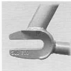
**Abb. 4: Nach hinten offenes Ausfallende eines Eingang-Rades**
