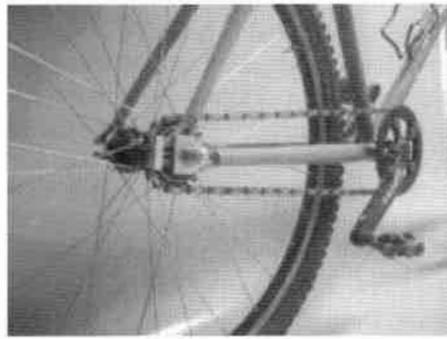
**Abb. 1: Beispiel für einen Antrieb mit nur einem Gang. Das Fahrzeug ist ein MTB, deshalb ist die Übersetzung klein**
