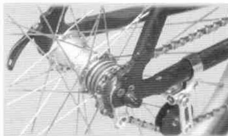
**Abb. 6: Alternative Kettenspannvorrichtung, an der Kettenstrebe montiert**
