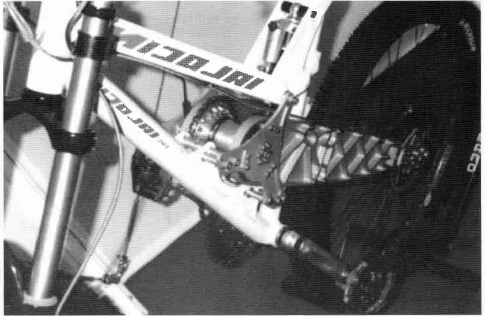
MTB „Nucleon“ der Rahmenschmiede „Nicolai“; Hinterrad und Antrieb sitzen auf einer Schwinge aus Gussteilen
