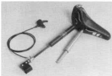
**Nachrüstbarer Sattellift der Fa. Hofmann: Mittels einer Gasdruckfeder wird der Sattel ferngesteuert gehoben und gesenkt**
