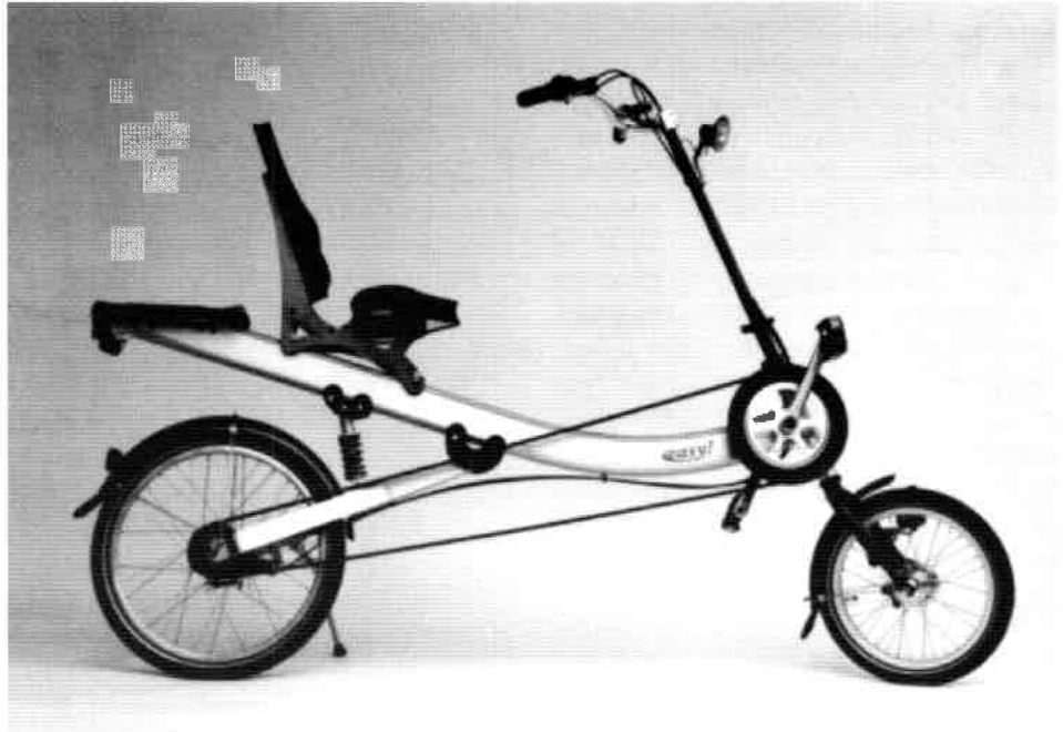
Senkels „easy“ aus Aluprofilen mit Klemmvorrichtungen ohne Schweißarbeiten montiert
