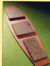
3 Die zweite Sperrholzplatte wird, bis der Leim ausgehärtet ist, beschwert; beispielsweise mit Gehweg-Platten
