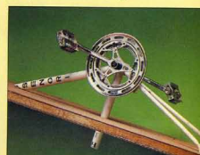
8 Das ist vom Rahmen übrig. Das Rohr links wird mit einem Lochband, das senkrecht durch einen Winkel fixiert
