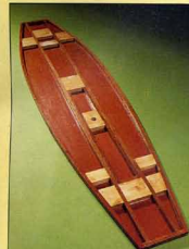
2 ... halten die beiden Sperrholzplatten auf Distanz. Nur an belasteten Stellen sind zusätzliche Platten eingeleimt
