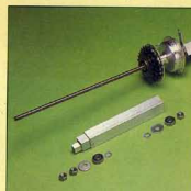
7 In die Hinterachsnabe mit Brems-trommel und Ser-Kettenblatt wird eine lange M12-Gewindestange geklebt
