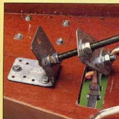
6 Der untere Teil der „Lenksäule“. Der Winkel dient als Lager. Ein Zapfen am Flachprofil lenkt die Räder
