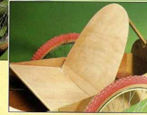
12 Die Abdeckung wird straff über die Spanen gelegt und mit Spangurten gehalten, bis der Leim völlig trocken ist. Rückenlehne und Sitz bestehen aus zwei Lagen Sperrholz (4 mm)
