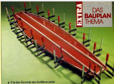
1 Um das Gewicht des Gefährts nicht unnötig zu erhöhen, entstand der Boden in Kastenbauweise. Leisten ...
