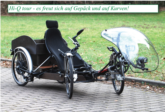
Prototypenbau: Velomo 4K, hölzern, Vollfederung, leichter Einstieg
