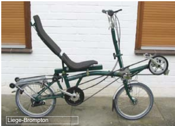
Sitzkonstruktion im Rohzustand vom Prototypen - wurde bis zum Schluss so gebaut.
