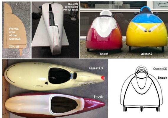
werden kann. Das Snoek (deutsche Aussprache: Snuuk, deutsche Übersetzung: Hecht) ist auf Geschwindigkeit ausgelegt, der Frontquerschnitt ist 20 % kleiner als der des Quest. Das Snoek ist für kleinere Fahrer bis ca. 1,80 m Körpergröße geeignet.
