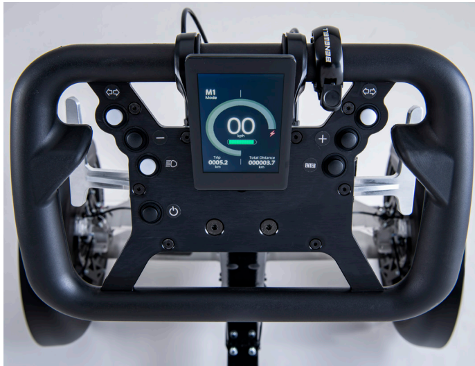
Steuereinheit, Stufenwahl: Plus / Minus, Blinker, Startknopf, Bremspedal, Display
