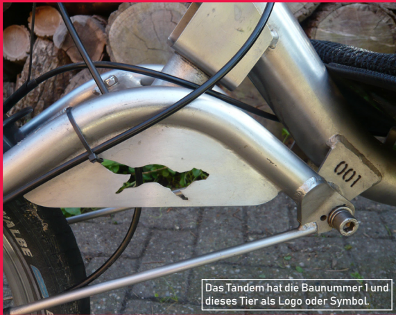
Das Hinterteil mit Antrieb, die Kette läuft „obenrum“ und nicht über Kreuz.
