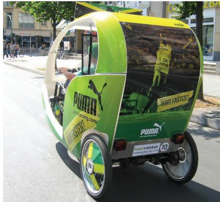
Personen transportiert werden können. Mit 190 kg Gewicht Leergewicht und zwei Fahrgästen, kommt man schnell auf ein Gesamtgewicht von ca. 400 kg. Bergauf kann es dann auch mit 250 Watt Elektrounterstützung schwierig werden.<sup>10)</sup>
