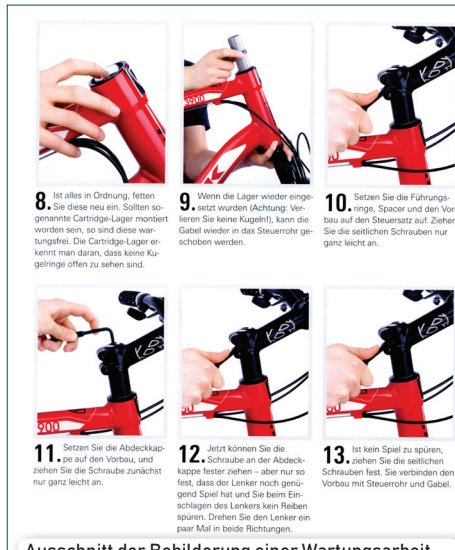
Ausschnitt der Bebilderung einer Wartungsarbeit.
