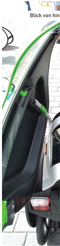
Verriegelung öffnen & Tretlagermast schwenken
