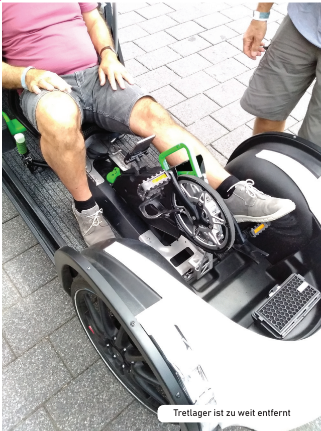
Verriegelung öffnen & Tretlagermast schwenken
