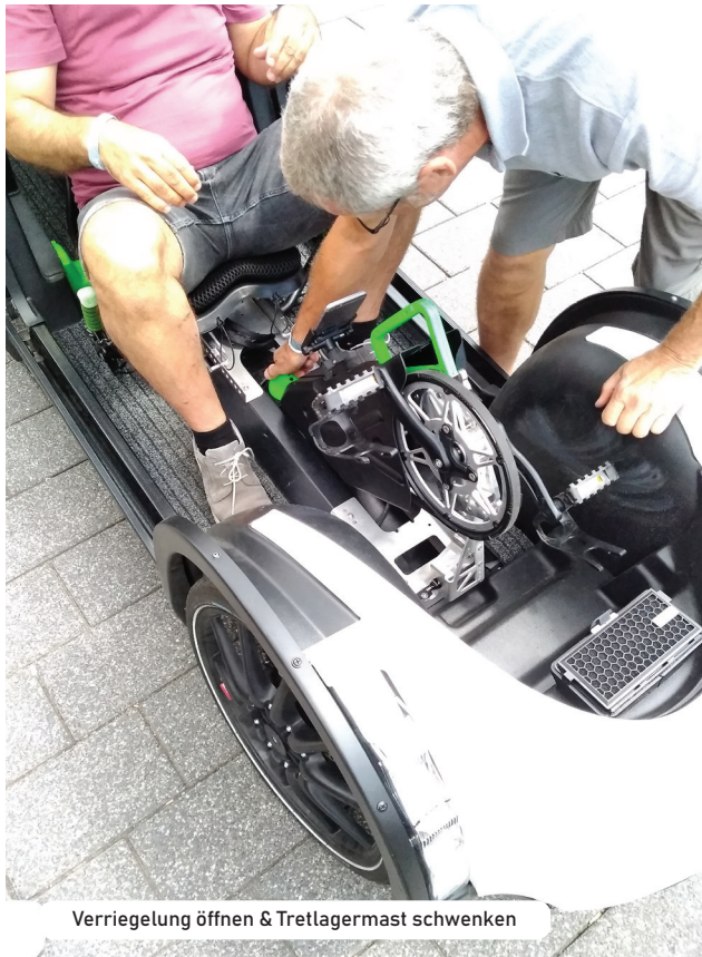
Tretlager ist zu weit entfernt
