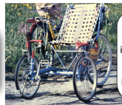
erster Kurzlieger - mangelhafte Lenkgeometrie: unfahrbar [1988]
