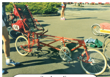
zweiter Langlieger, vollgefedert (Stiffelfederungen) - Helmstedt DM 1992
