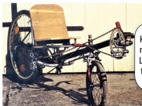
erster Langlieger - Hinterrad mit Steckachse - solide, bequem [1990]
