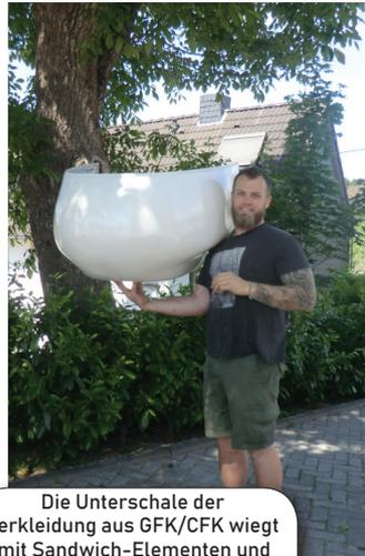
Die Unterschale der Verkleidung aus GFK/CFK wiegt mit Sandwich-Elementen und Metallbeschlägen nur 3,2 kg.
