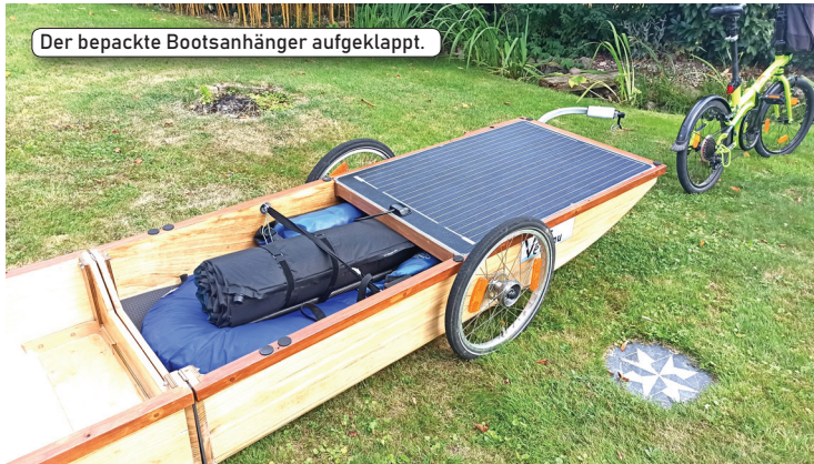
Die Räder brauchen erst im Wasser abgebaut zu werden.
