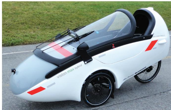
ich deswegen nachträglich einen Go Swiss Drive Radnabenantrieb mit Rekuperation eingebaut. Aktuelles Gewicht mit Bauchgurten, El.-Antrieb, zwei Akkus usw.: 87 Kg.
