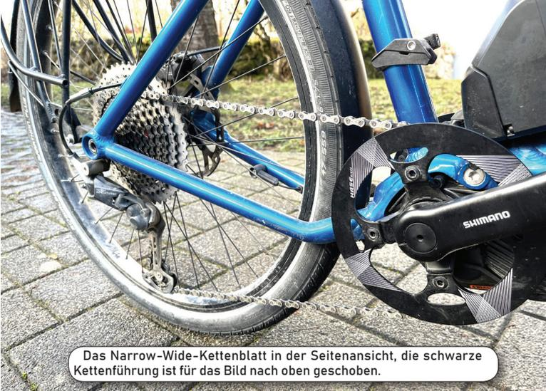
Das Narrow-Wide-Kettenblatt in der Seitenansicht, die schwarze Kettenführung ist für das Bild nach oben geschoben.
