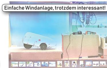
Mit der einfachen Windanlage wurde versucht, anhand verschiedener Modelle im Massstab 1:5 die Windflüsse gleicher Fahrzeuge, jedoch Variante unten offen und Variante unten geschlossen, zu beobachten und zu vergleichen. Durch den Versatz der Modelle mit und ohne Wind
