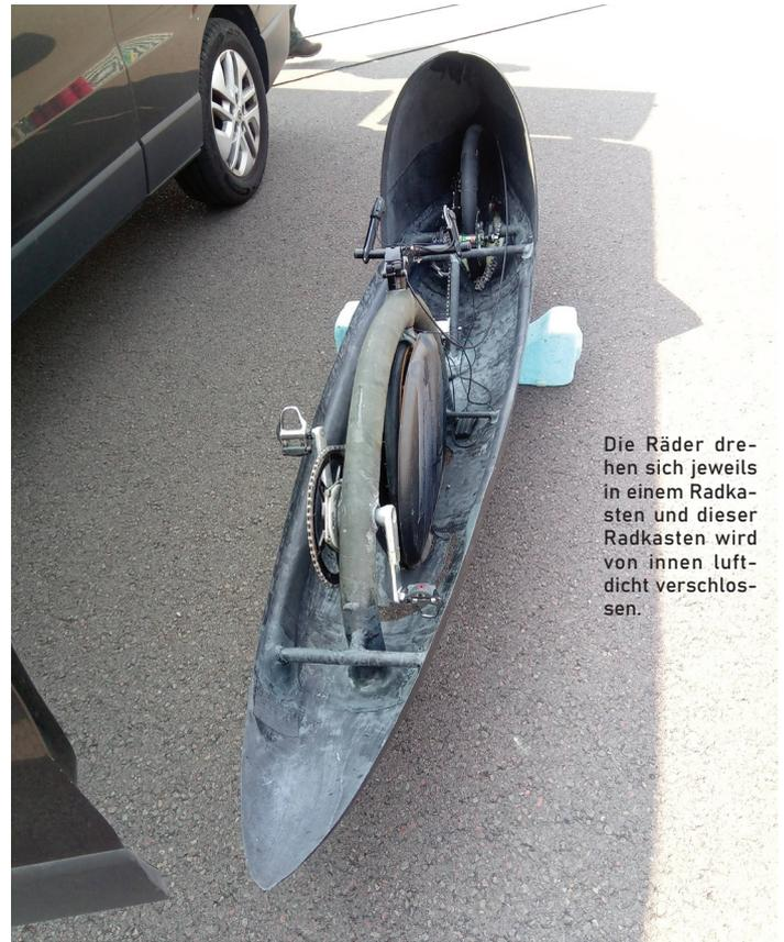
Die Räder drehen sich jeweils in einem Radkasten und dieser Radkasten wird von innen luftdicht verschlossen.
